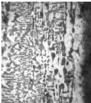
Рис. 4. Микроструктура слоя контактного плавления, образовавшегося на границе сплав системы Co–Fe–TaC–графит при давлении 5 ГПа,  $\times 500$
