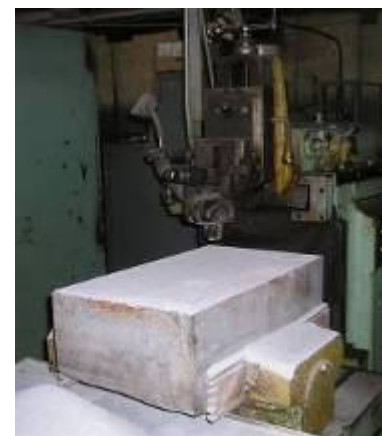
Рис. 4. Общий вид стенда на базе поперечно-строгального станка 7В36
