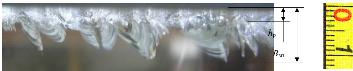
Рис. 3. Образец стекла с резом глубиной 2 мм и зоной предразрушения 10 мм
