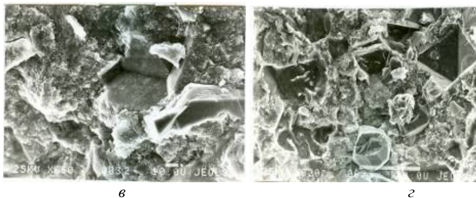
Рис. 1. Морфология поверхностей излома композиционных материалов: а – 70 об. % стекла, фракции 50/40 мкм, давление горячего прессования 40 МПа; б – 80 об. % стекла, фракции 50/40 мкм, давление горячего прессования 70 МПа; в – 70 об. % стекла, фракции 80/63 мкм, давление горячего прессования 40 МПа; г – 780 об. % стекла, фракции 80/63 мкм, давление горячего прессования 70 МПа
