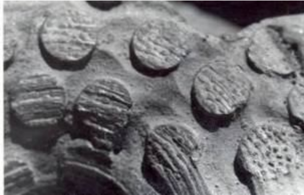
Рис. 1. Внешний вид рабочей поверхности алмазного долота, оснащённого вставками славутича
