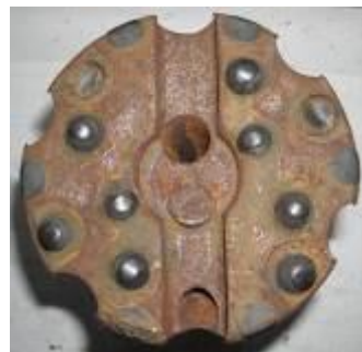
Рис. 1. Внешний вид торца коронки КНТУ 110 после бурения 31 п.м. по кварцитам ( f = 17 - 18 ; K_{y.б.} = 31 ).
