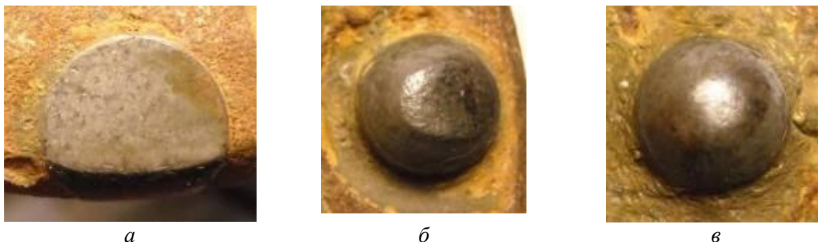
Рис. 2. Внешний вид изношенной поверхности твёрдосплавных вставок, расположенных на трех окружностях корпуса коронки от периферии к центру: а – 108мм, б – 98мм, в – 70мм.
