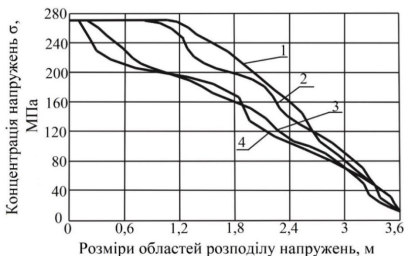
Рисунок 3. Залежність зміни концентрації напружень \sigma_{\max} при надпрацюванні виробки лавою для кріплення: 1 – базове металеве кріплення, 2 – композитне кріплення 33, 3 – композитне кріплення 36, 4 – композитне кріплення 39
