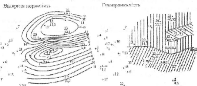
Рис. 4. Зміна відкритої пористості і газопроникності. Новомиколаївська площа. Іваницин В. А., 1979 р. місткістю породи-колектори відносяться до III класу (середня місткість), за проникністю – до V класу (низька проникність), а загалом це колектори IV–V класів.
