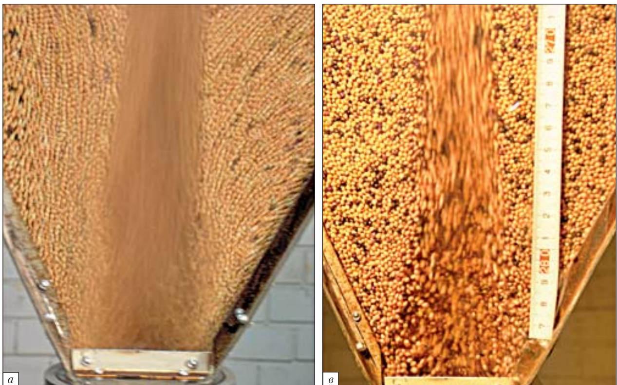
Рис. 5. Определение структурных характеристик фонтанирующего слоя на маломасштабной установке (пшено, "полукруговая" модель, \alpha = 52^\circ ): а – экспозиция 1/2 с; б – экспозиция 1/1000 с
