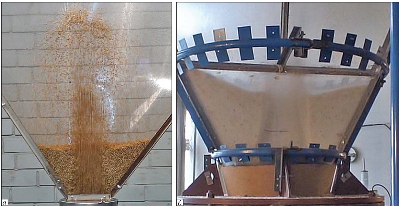
Рис. 4. Фонтанирующий слой в маломасштабной (а) и полномасштабной (б) установках ("полукруговая" модель, \alpha = 52^\circ )
