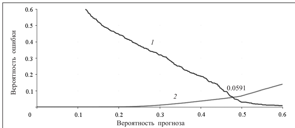
Рис. 6. Графики вероятностей ошибок первого рода (кривая 1) и второго рода (кривая 2) выявления пауз с признаками монтажа в реальных речевых фонограммах
