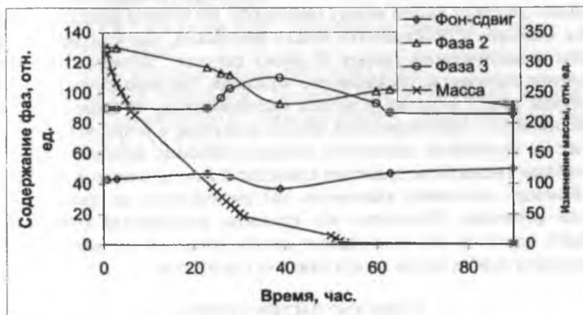
Рис 8. Зависимость содержания фаз  $\Phi$  и интенсивности  $\varphi$  фона от времени дегазации метана.
