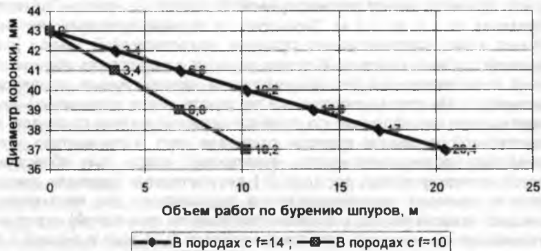
Рис. 1. Графики уменьшения диаметров коронки в зависимости от объема выполненной работы по бурению шпуров.
