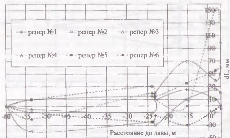
Рис. 3. Замеры изменения длины участка подготовительной выработки при накате лавы взятые относительно начального.
