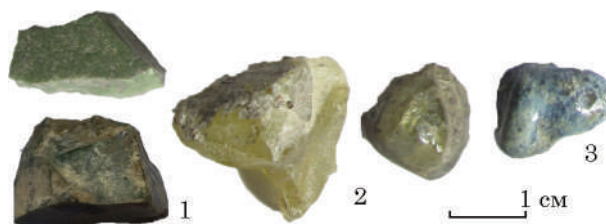
Рис. 4. Сліди склоробної справи з розкопок В. А. Богусевича 1950 р. на Київському Подолі: 1 — фрагменти мозаїчних пластин-заготовок, 2 — фрагменти торгового скла, 3 — скляний шлак
