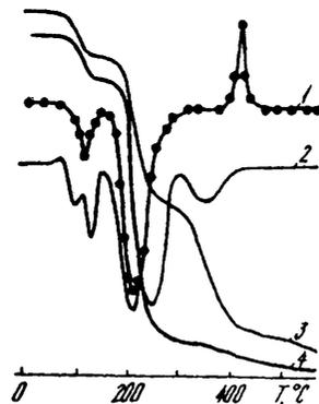
Рис. 1. Кривые ДТА (1, 2) и ТГ (3, 4) для  $ZrO(NO_3)_2 \cdot 2H_2O$  (1, 4) и  $ZrO(NO_3)_2 \cdot 2H_2O \cdot (K, Na)NO_3$  (2, 3).
