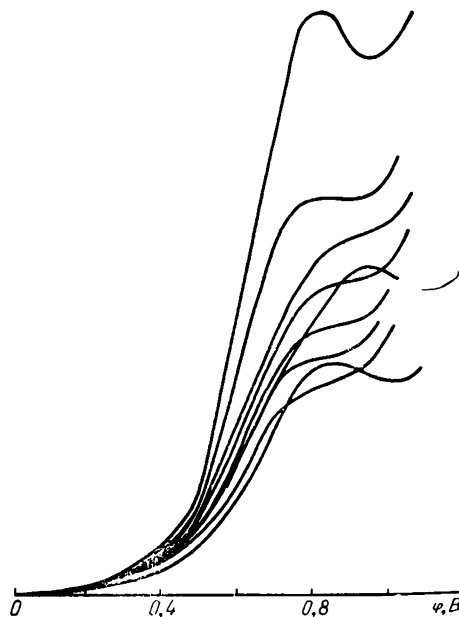
Рис. 1. Анодные хроновольтамперограммы, снятые на электроде СУ-2500 в расплаве \text{KCl-NaCl-KMoO}_4 ( C_{\text{MoO}_4^{2-}} = 3 \cdot 10^{-5} моль/см 3 ). Скорость поляризации 0,126-46 В/с.
