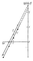
и толуола с ПДБС; c — концентрация ПДБС, моль/л; K — термодинамическая константа образования комплекса при концентрации ПДБС, равной 1 моль/л.
