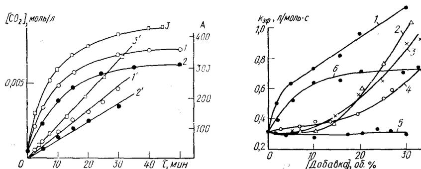
Рис. 1. Кинетические кривые выделения  $\text{CO}_2$  в газовую фазу (1—3) и их анаморфозы (1'—3') в зависимости от природы добавки ( $C=5$  об. %): 1, 1' — этиловый спирт; 2, 2' — пропиловый спирт; 3, 3' — *n*-ксилол.  $[\text{Ca}(\text{HCO}_3)_2]_0 = 0,0094$  моль/л;  $T=65^\circ$ .
