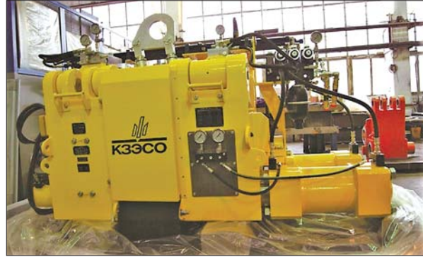
Рейкозварювальний комплекс K945 на Каховському заводі електрозварювального устаткування. Розробка Інституту електрозварювання ім. Є.О. Патона НАН України
