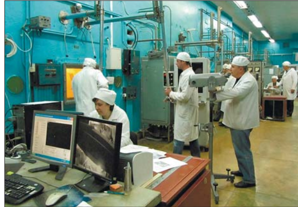
Операторський зал «гарячих» камер. Дослідження зразків-свідків металу корпусу реактора. Інститут ядерних досліджень НАН України
