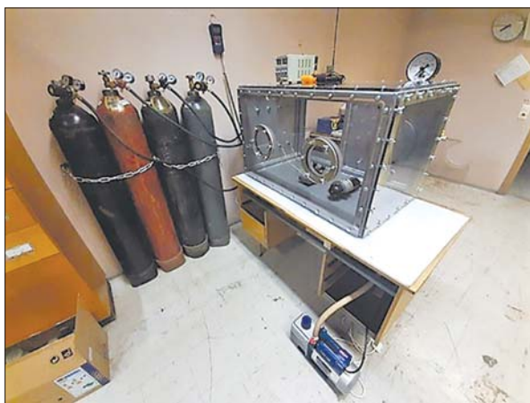
Дослідна камера для моделювання аномальних умов з метою вивчення особливостей зварювання та 3D-друку полімерних конструкцій у цих умовах
