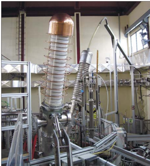
Розроблена за участі українських фахівців система безконтактної діагностики плазми пучками важких іонів на стелараторі TJ-II (CIEMAT, Іспанія)
