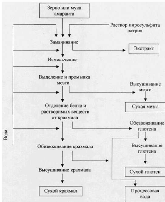
Рис. 1. Принципиальная схема переработки зерна амаранта на лабораторной установке “завод на столе” по сернисто-кислотному способу
