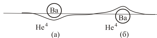
Рис. 5. Варианты взаимодействия цилиндрического тяжелого поплавка с поверхностью жидкости (тяжелым называем поплавок, имеющий плотность большую, чем плотность жидкости). Жидкость не смачивает поверхность цилиндра, изготовленного из металлического бария. Механическое равновесие с конкуренцией между локальным давлением поплавка на поверхность жидкости и силами поверхностного натяжения жидкости в определенных рамках возможно (а). В альтернативных условиях рис. 5(б) со смачиванием поверхности металла равновесия нет. Поплавок должен утонуть (б).
