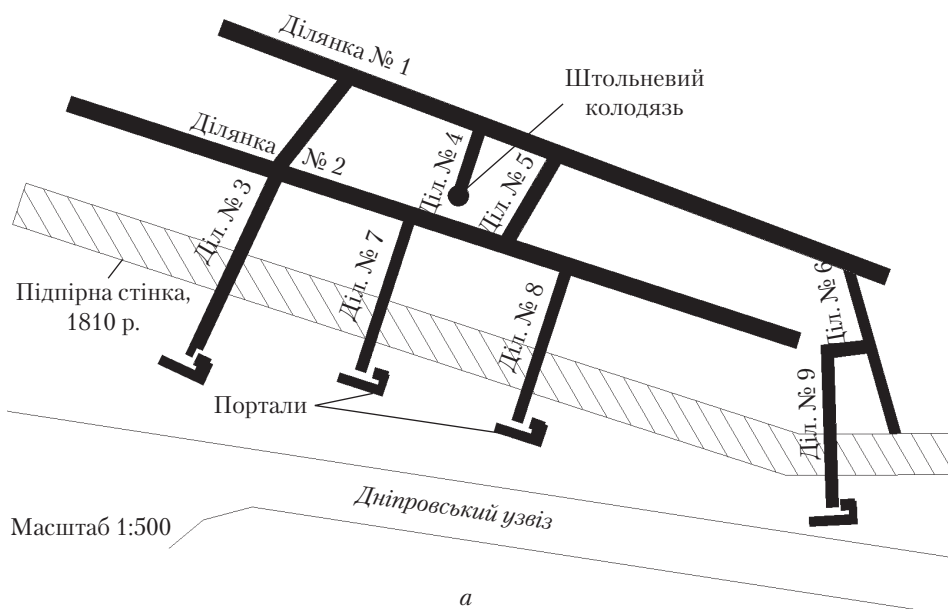
Рис. 3. Схема положення комплексної споруди за проектом Петра Сухтелена (ДШС-18 і підпірної стінки) в плані (а) та конструкційне виконання дренажних виробок (б)
