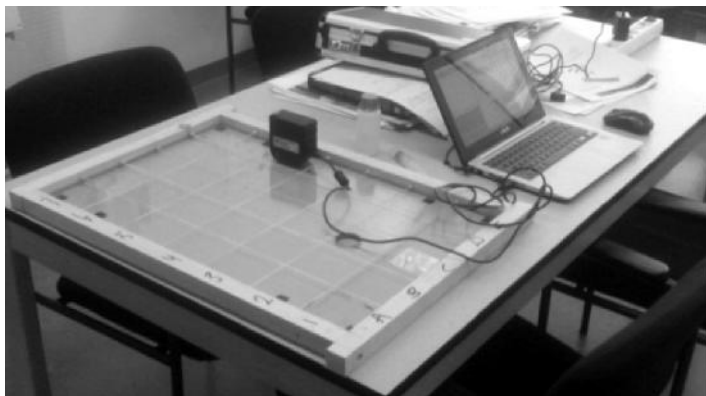
Рис. 5. Вимірювання залишкових напружень стиску \sigma^{res} у пластині термічно зміцненого скла оптично-поляризаційним методом із застосуванням лазерного інтерферометра Scalp 4.
