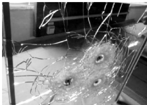
Рис. 3. Руйнування захисного блоку з HS-скла.
