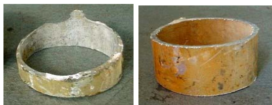
Рис. 2. Внешний вид поверхности оболочки стержня автоматического регулирования после эксплуатации и длительной выдержки во временном водном хранилище реактора ВВР-К
