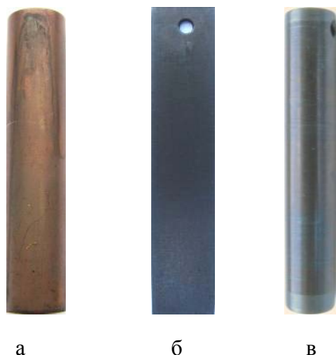
Рис. 5. Внешний вид образцов сталей 06X18H10T (а), 08X18H10T (б), 12X18H10T (в) после испытаний в течение 6000 ч при температуре 350 °С в воде с рН=7,2
