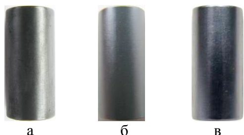
Рис. 3. Внешний вид поверхности труб-оболочек сплава Э110 после 6000 ч коррозионных испытаний при температуре 350 °C и давлении 16,5 МПа в средах с разными pH: а - среда 1 (pH=5,0); б - среда 2 (pH=7,2); в - среда 3 (pH=10,0)
