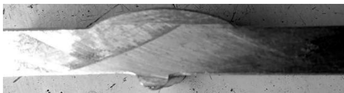
Рис. 1. Стыковое сварное соединение алюминиевого сплава 6061-Т6, выполненное аргонодуговой сваркой плавящимся электродом (АДСПЭ) на съемной подкладке.
