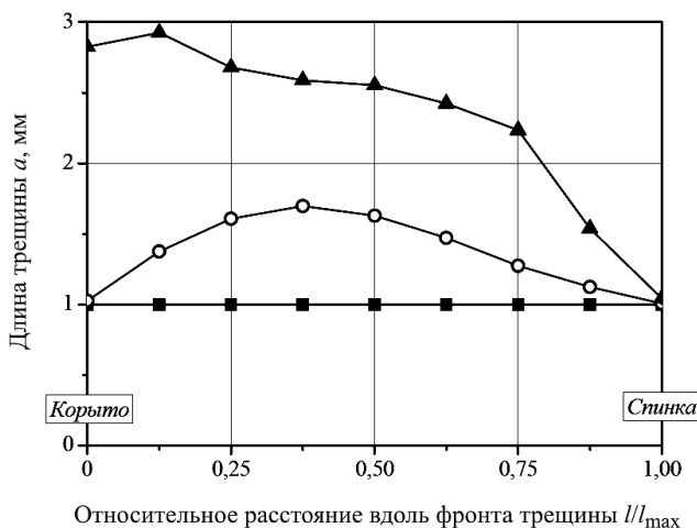
Рис. 6. Эволюция фронта усталостной трещины с ростом числа циклов: ■ – начальный фронт трещины; ○ – фронт трещины на базе 10^7 цикл; ▲ – фронт трещины на базе 2 \cdot 10^7 цикл. (Расстояние измеряется вдоль фронта трещины (от корыта к спинке).)
