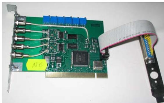
Рис.3. Внешний вид АЦП ADC-02
