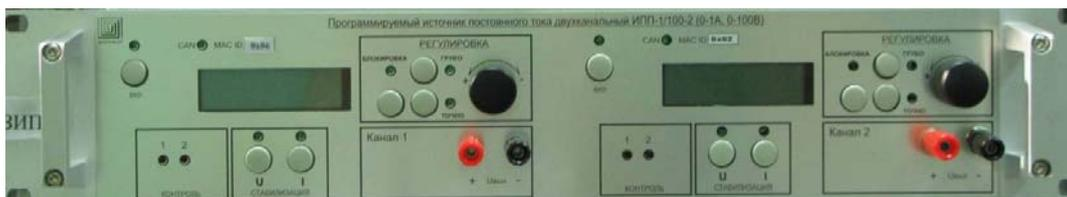
Рис.4. Вид блока питания постоянного тока типа ИПП-1/100 с передней панели
