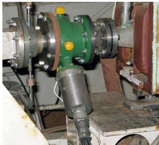
Рис.7. Внешний вид блока коллиматора с двумя пролётными датчиками
