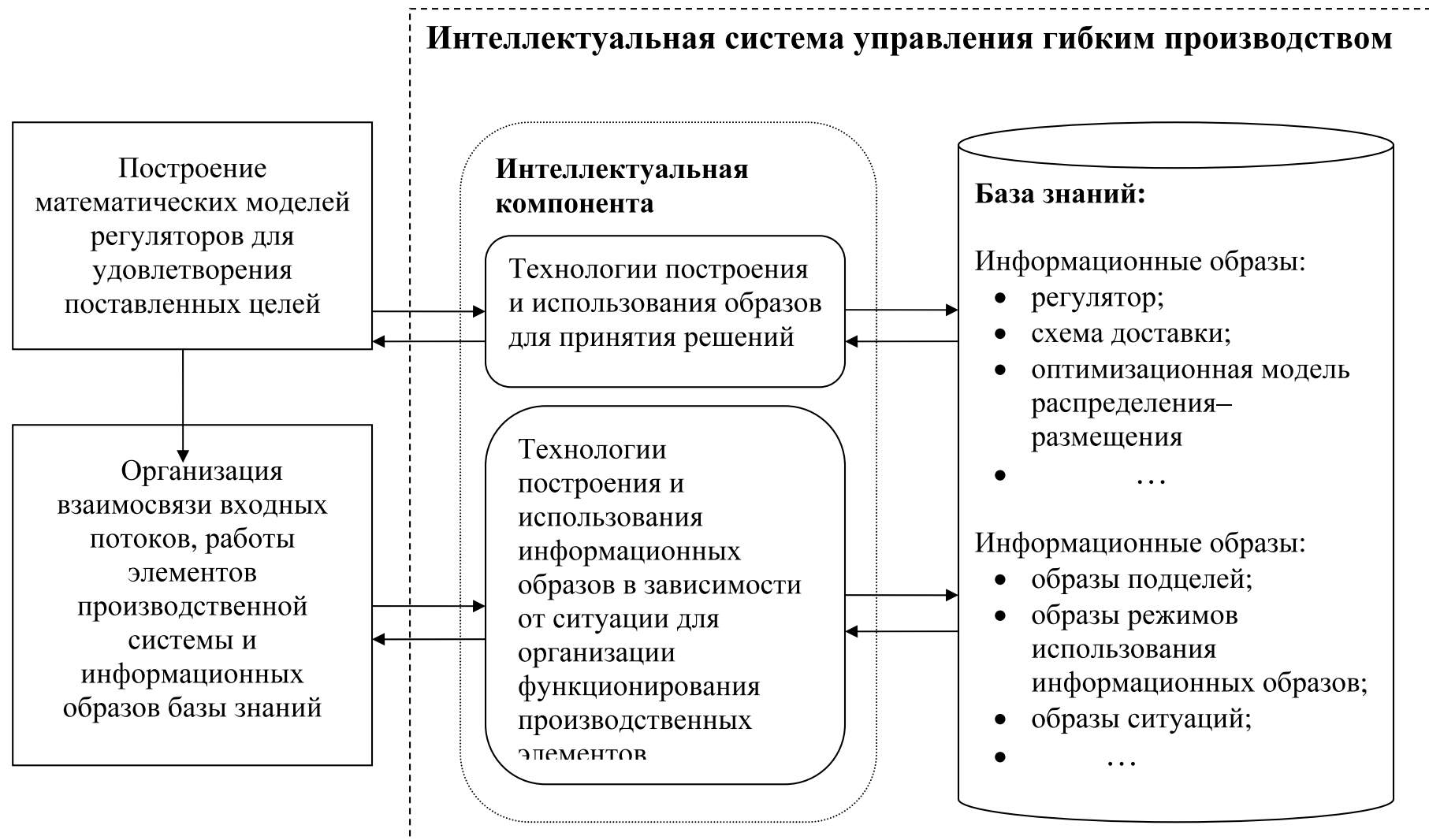
Рис. 1. Схема конструирования интеллектуальной системы управления цехом гибкого производства
