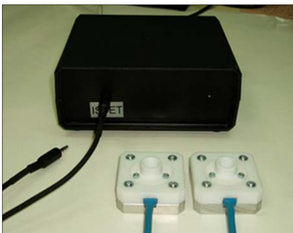
Рис. 2. Мультисенсор на основі ІСПТ для визначення функціональних порушень роботи нирок та якості процесу гемодіалізу
