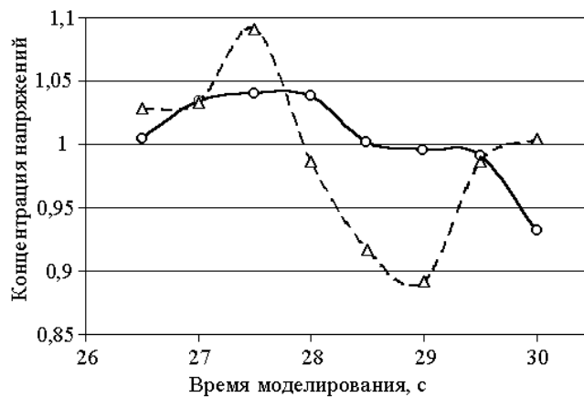
Рис. 2. Динамика изменения коэффициента концентрации напряжений над краевой частью массива и над посадочным рядом механизированной крепи в процессе обрушения слоя кровли: о – на забое, Δ – на стойке
