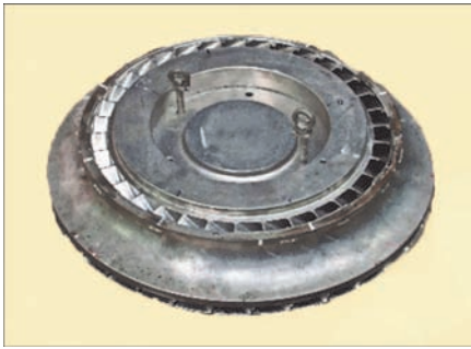
Рис. 19. Центробіжне колесо компресора газотурбінного двигуна, яке виготовлено із застосуванням нового припою шується до 7 разів в залежності від рівнів прикладених навантажень.
