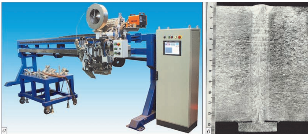
Рис. 11. Зварювальне обладнання УД 682 для зварювання і наплавлення деталей товщиною до 110 мм та довжиною до 4 м (а) та макрошліф зварного з'єднання (б)
