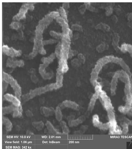
Рис. 4. Зображення ВНТ, синтезованих з крупних наночастин на суцільній “шкірці” на підкладці з SiO_2 , при різному збільшенні.
