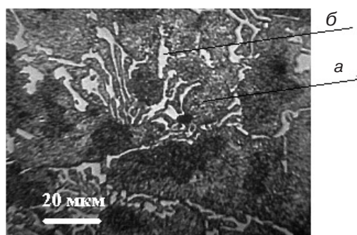
Рис. 1. Структура лигатуры FeCrC: а – зёрна сорбитизированного перлита, б – карбидная сетка
