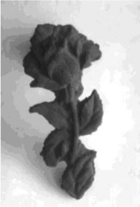
Рис. 5. Отливка «Роза» (сталь 20Л), полученная в разъемной форме
