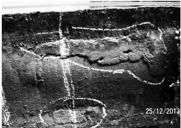
Рис. 4. Фото узкой грани сляба с участками «залечившихся» микропрорывов
