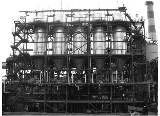
Рис. 6. Система очистки доменного газа в рукавном фильтре ФРИР 550х9
