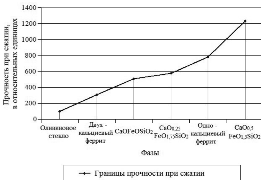
Рис. 1. Сравнение характеристик прочности при сжатии вторичных фаз агломерата, по отношению к оливиновому стеклу
