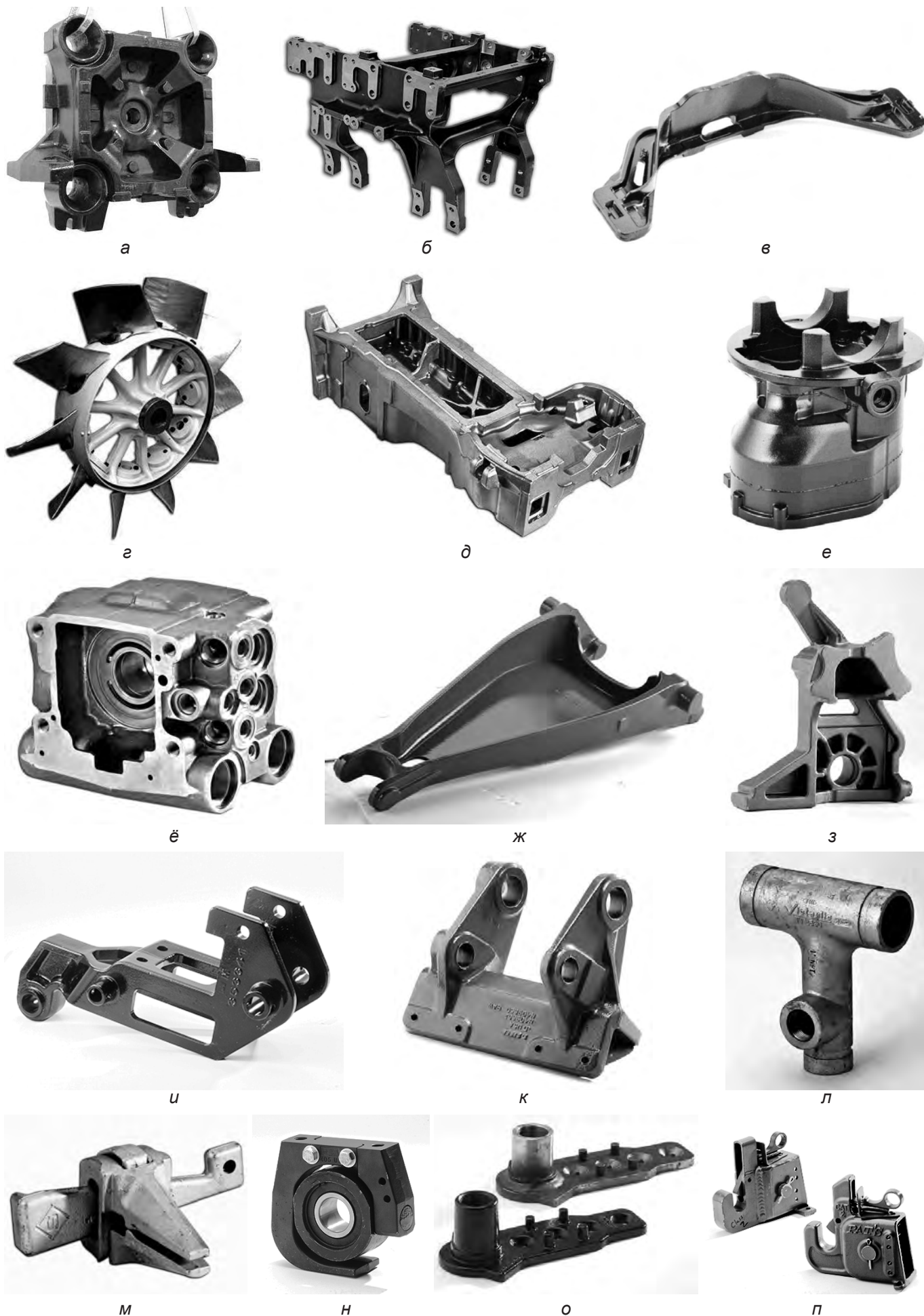
Рис. 3. Отливки из ВЧ в галерее «Отливка года» 2013-2015 гг. ( www.afsinc.org )
