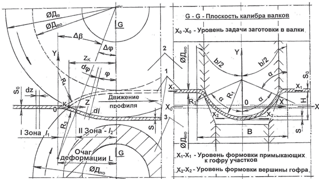
Рис. 5. Схема очага деформации при формообразовании на листовой заготовке 1 в валках 2 и 3 желобчатого гофра с рекомендуемым уровнем задачи заготовки в валки, проходящим через точку К
