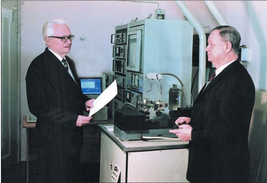
Валентин Володимирович Матвєєв і Анатолій Петрович Яковлев біля експериментальної установки Д6-М для дослідження дисипативних властивостей конструкційних матеріалів. 2001 р.
