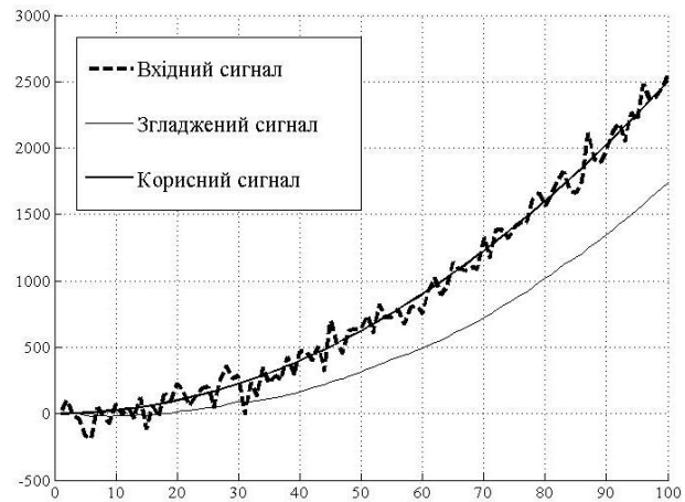
Рисунок 5 – Процес згладжування фільтром Р. Брауна суми квадратично зростаючого сигналу x(k) = 0,25k^2 і випадкового збурення
