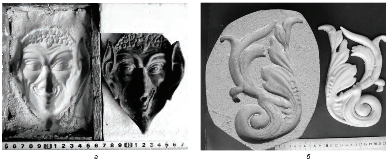
Рис. 3. Примеры послойной формовки при изготовлении песчаных полуформ: по металлической модели «Мепhistофель» (а) и орнамента по ледяной модели (б)
