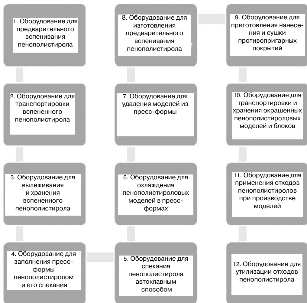
Рис. 2. Блок-схема состава технологического оборудования для изготовления литейных пенополистироловых моделей
