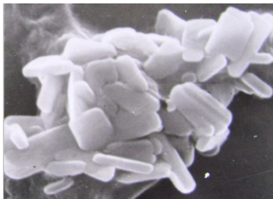
Рис. 2. Конгломерат из коллоидных частиц стекла, собранных при его полировании
