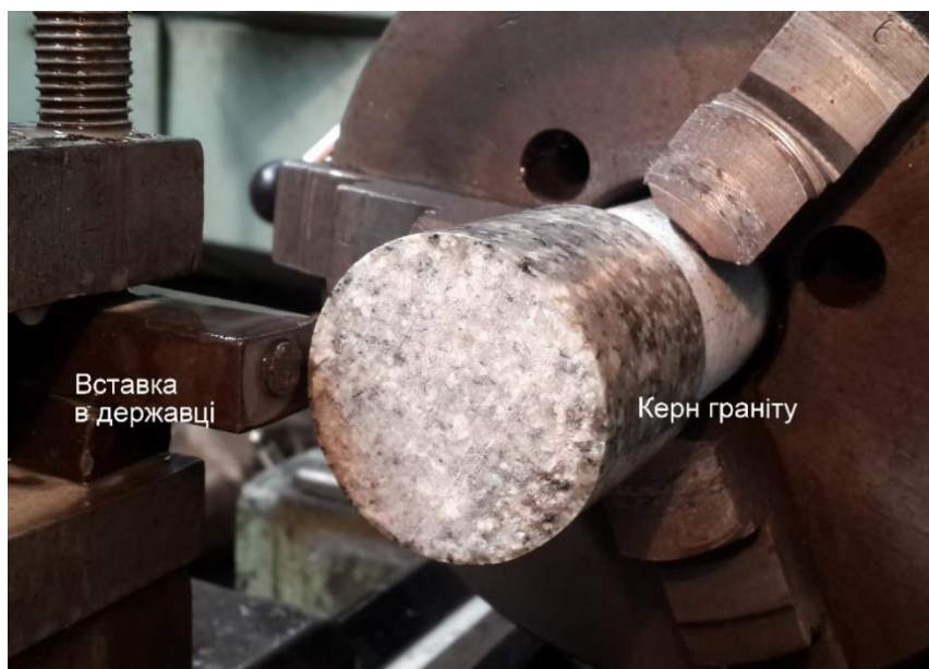
Рис. 1. Зовнішній вигляд стенду для дослідження зносостійкості породоруйнівних вставок
