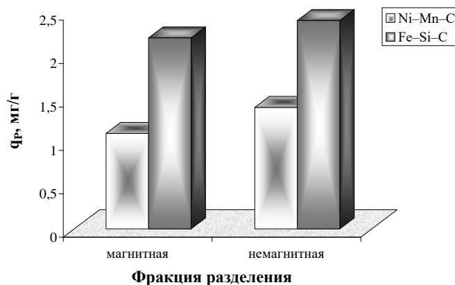
Рис. 4. Износостойкость кругов с кристаллами алмаза, синтезированными в системах Ni-Mn-C и Fe-Si-C
