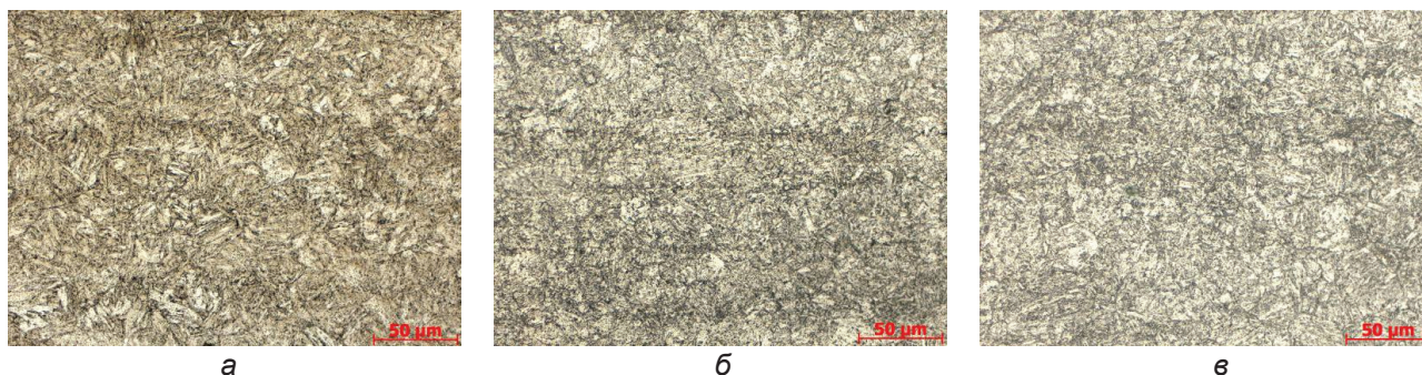
Рис. 1 Микроструктура стали 17Х5МА при различных режимах термической обработки: режим 1 (а); режим 4 (б); режим 5 (в); \times 500
