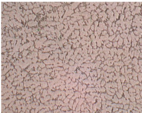
Рис. 3. Влияние плазменной обработки расплава на микроструктуру (X100) сплава АК7: а – до обработки; б – плазменной струей аргона; в – плазменной струей с парами флюса
